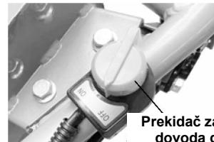
Prekidač za prekid dovoda goriva
